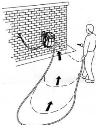
2. Le cliquet de blocage automatique maintiendra le tuyau à sa place à la longueur souhaitée. Le mécanisme fera "clic" quand que le tuyau est bloqué en un point ou qu'il est en train d'être enroulé.
