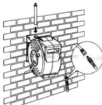
4. Accoupler le tuyau de raccordement de 2m qui va de l'enrouleur à votre robinet en utilisant l'adaptateur universel pour robinets. Faire un essai pour s'assurer que l'enrouleur pivote librement 180° avec l'adaptateur de robinets raccordé.
