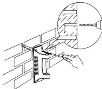
3. Alinee la parte trasera del enrollador con el soporte de pared e inserte el pasador de seguridad por la junta.
