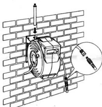
4. Acoplar o conector de 2m que vai da torneira ao enrolador a sua torneira usando o adaptador universal para torneiras. Faça uma prova para garantir que o enrolador rota livremente 180° com o adaptador de torneiras conectado.
