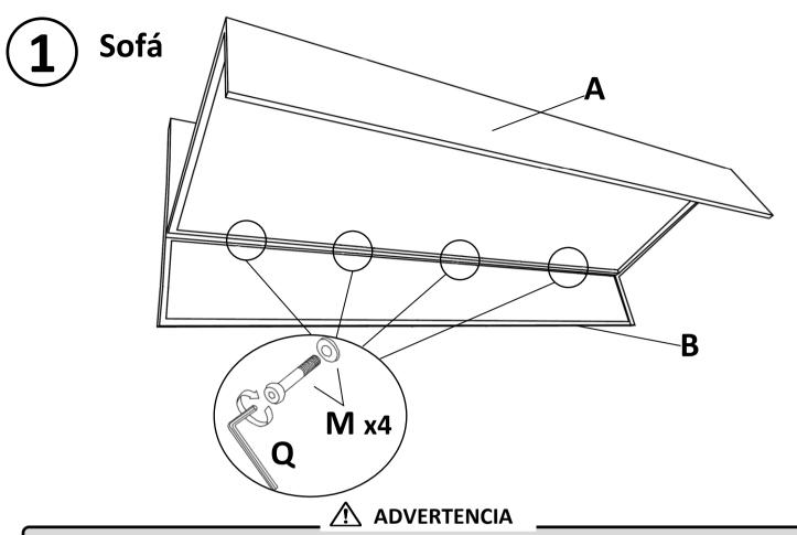
Coloque todos los tornillos antes de apretarlos completamente al montar los elementos.
